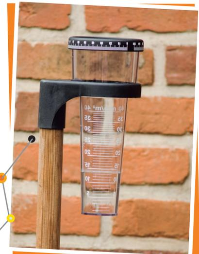
El pluviómetro sirve para medir las precipitaciones.
