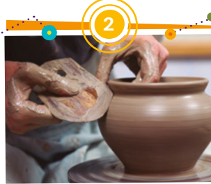
2 Se moldea la pasta con un torno, una máquina que tiene un plato giratorio.
