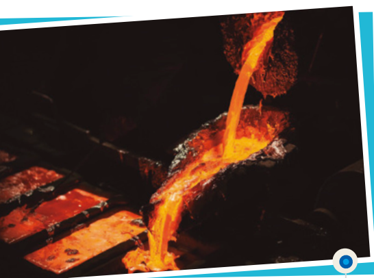
Aluminio líquido dentro de los moldes.
