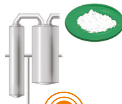
4 El gas etileno se envía a otra torre y se lo transforma en polvo de polietileno.
