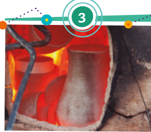
3 El objeto se cuece en hornos a alta temperatura.
