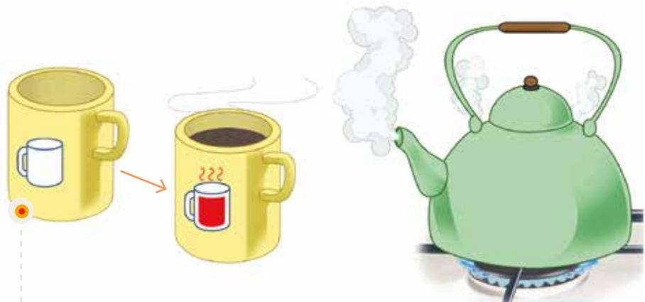
Al colocar un líquido caliente en la taza, el material termosensible cambia de color.
