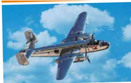
El aluminio se utiliza en la fabricación de aviones por su ligereza, resistencia y ductilidad.
