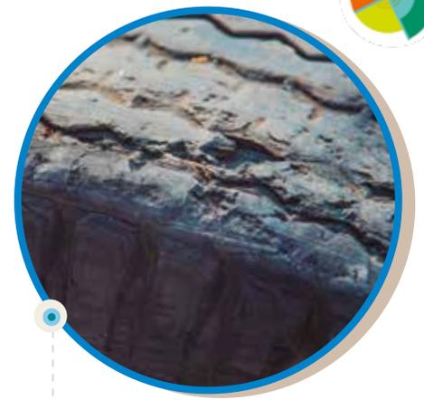
Los neumáticos de los automóviles se gastan debido a la fuerza de rozamiento con el asfalto. De esa manera se vuelven menos rugosos, y el auto puede patinar. Por eso, hay que cambiarlos periódicamente.
