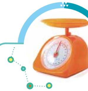
Las balanzas mecánicas de cocina funcionan, como los dinamómetros, en base a un resorte. Pero, en lugar de colgar el objeto de un resorte, se coloca sobre un platillo. Este último a su vez está apoyado sobre un resorte, el cual se comprime por el peso, en lugar de estirarse. El peso del objeto se mide, entonces, según la compresión del resorte.
