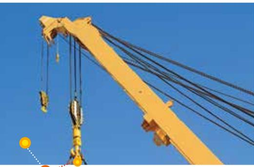
Las grúas utilizadas en las construcciones funcionan con sistemas de poleas que les permiten mover bloques de materiales muy pesados.
