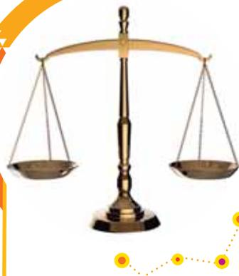
La balanza de platillos (o balanza clásica) tiene dos brazos que se sostienen de un punto medio, de los que cuelgan dos platillos. En uno de ellos debemos colocar una serie de pesas de un peso conocido, y en el otro, el objeto a pesar. Cuando los platillos se equilibran, significa que ambos pesan lo mismo. Son utilizadas en las joyerías.
