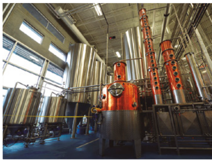
Las destilerías producen desde perfumes hasta bebidas alcohólicas usando el método de destilación.
