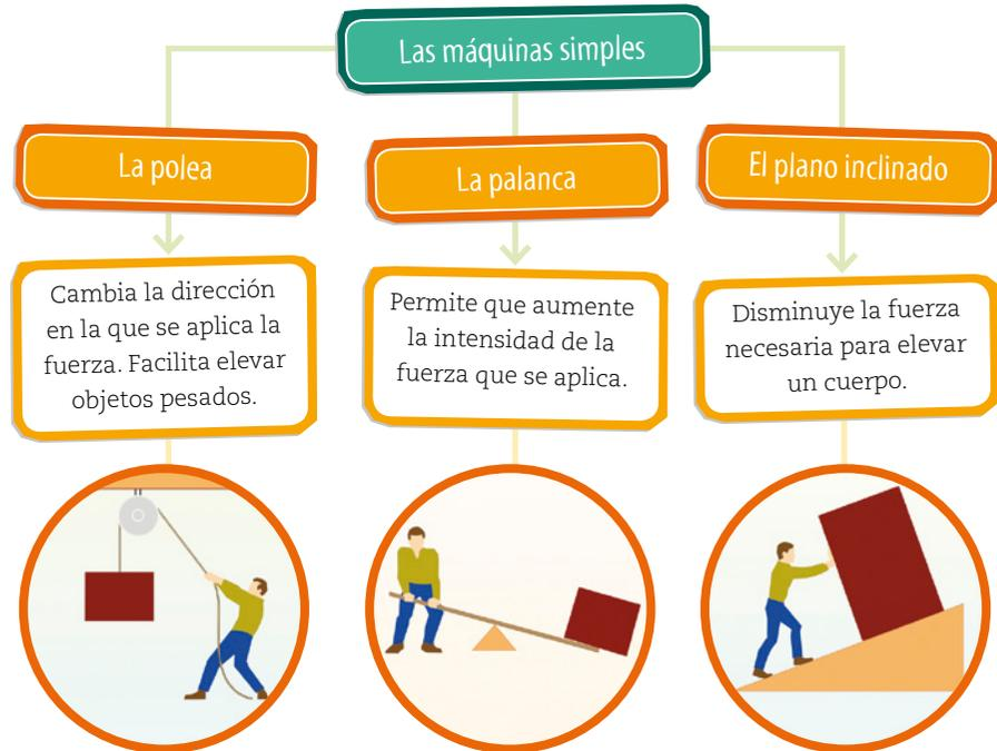
Las poleas se utilizan para levantar objetos muy pesados. Una polea consiste en una rueda con un surco por el que pasa una cuerda. Su función es doble: aumentar una fuerza aplicada o, simplemente, cambiar la dirección de la fuerza. Muchas veces se combinan, y forman sistemas de poleas que permiten amplificar aún más una fuerza aplicada. Se usan, por ejemplo, para sacar agua de un pozo con un balde.
