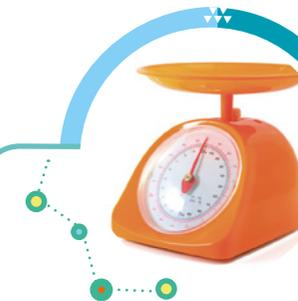
Las balanzas mecánicas de cocina funcionan, como los dinamómetros, en base a un resorte. Pero, en lugar de colgar el objeto de un resorte, se coloca sobre un platillo. Este último a su vez está apoyado sobre un resorte, el cual se comprime por el peso, en lugar de estirarse. El peso del objeto se mide, entonces, según la compresión del resorte.
