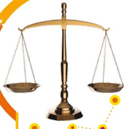
La balanza de platillos (o balanza clásica) tiene dos brazos que se sostienen de un punto medio, de los que cuelgan dos platillos. En uno de ellos debemos colocar una serie de pesas de un peso conocido, y en el otro, el objeto a medir. Cuando los platillos se equilibran, significa que ambos pesan lo mismo. Son utilizadas en las joyerías.
