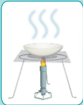
Es un método sencillo que se utiliza para separar un sólido disuelto en un líquido. Para eso, se calienta la solución hasta que se evapora todo el solvente y queda el soluto en forma sólida.
