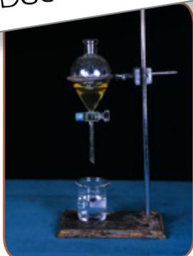
Se aplica para separar una mezcla de líquidos inmiscibles, es decir, que no se mezclan entre sí, o un sólido insoluble de un líquido. En el caso de un sólido, este se deposita en el fondo del recipiente y luego se trasvasa el líquido a otro recipiente. En el caso de dos líquidos inmiscibles, se emplea un dispositivo llamado "ampolla de decantación". La ampolla tiene una llave, que se abre y se cierra para dejar pasar primero un líquido y después el otro.
