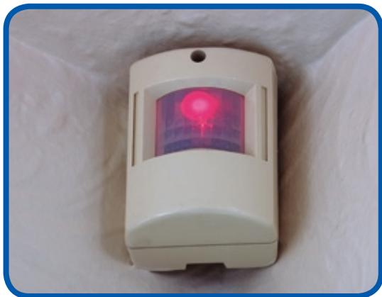
Los detectores infrarrojos son dispositivos electrónicos que pueden medir la radiación calórica que emiten los cuerpos.
