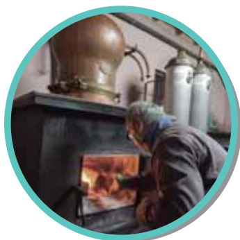
Antiguamente, se utilizaba la leña para calentar la solución en los alambiques y lograr separar los componentes.
