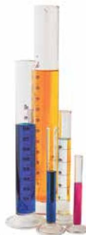
La probeta graduada sirve para medir volúmenes de líquidos. En los laboratorios se usan probetas graduadas de distintas capacidades.
