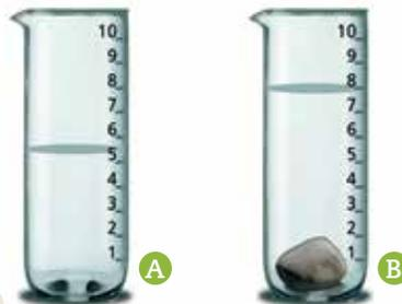
En este ejemplo, se calcula que el volumen de la piedra es de  $2,5 \text{ cm}^3$  restandole a la medición B ( $8 \text{ cm}^3$ ) la medición A ( $5,5 \text{ cm}^3$ ).
