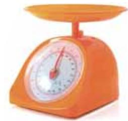
Las balanzas mecánicas de cocina funcionan, como los dinamómetros, en base a un resorte. Pero, en lugar de colgar el objeto de un resorte, se coloca sobre un platillo. Este último a su vez está apoyado sobre un resorte, el cual se comprime por el peso, en lugar de estirarse. El peso del objeto se mide, entonces, según la compresión del resorte.
