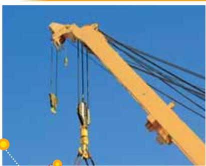
Las grúas utilizadas en las construcciones funcionan con sistemas de poleas que les permiten mover bloques de materiales muy pesados.
