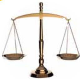
La balanza de platillos (o balanza clásica) tiene dos brazos que se sostienen de un punto medio, de los que cuelgan dos platillos. En uno de ellos debemos colocar una serie de pesas de un peso conocido, y en el otro, el objeto a medir. Cuando los platillos se equilibran, significa que ambos pesan lo mismo. Son utilizadas en las joyerías.
